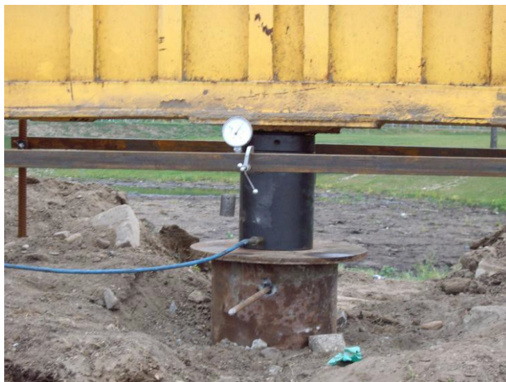
4 pav. Nuosėdžių matavimo indikatorius sumontuotas ant nepriklausomo sijyno
